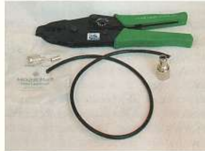
Alle onderdelen voor een pigtail RP-SMA naar male-N met connector krimptang.
